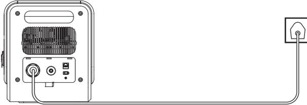
2. Bitte verbinden Sie den Anschluss des Photovoltaik-Solarmoduls mit dem Ladeanschluss des XT60 an der Seite der Stromstation.
