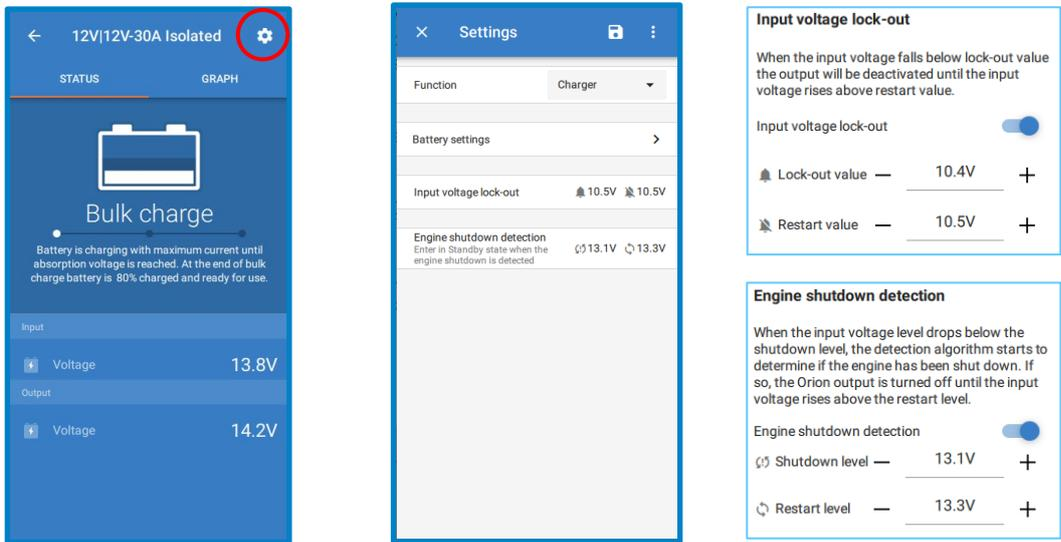
**(Re)start-Level:** Die Standardeinstellung (13,3 V) basiert auf der allgemeinen intelligenten Lichtmaschineneinstellung. Die meisten intelligenten Lichtmaschinen erzeugen 13,5 V, wenn der Motor läuft, und normale Lichtmaschinen erzeugen normalerweise >14 V. In einer Anwendung mit einer normalen Lichtmaschine kann das Wiederanlass-Level daher auf einen höheren Wert eingestellt werden, z.B. 14 V.
