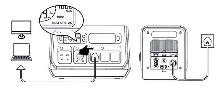
UPS-Bypass-Modus: Verbinden Sie die Stromstation mit der Wechselstromversorgung und schalten Sie dann die Wechselstromausgabe ein. Das Display zeigt "UPS AC" an. In diesem Modus wird die Wechselstromversorgung direkt die Lasten an den Wechselstromausgangsanschlüssen unterstützen und die Einheit aufladen. Hinweis: Maximale Ausgangsleistung: 1800 W.
