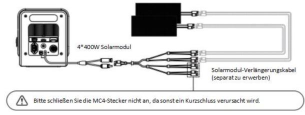
Dieses Kraftwerk unterstützt nicht den gleichzeitigen Anschluss von drei Solarmodulen.
