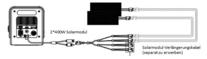
Dieses Kraftwerk kann bis zu 4 in Reihe geschaltete Solarmodule gleichzeitig unterstützen.
