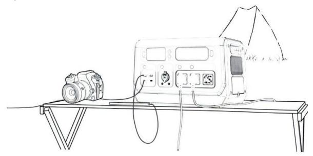
Im netzunabhängigen Modus unterstützt diese Stromtankstelle das gleichzeitige Laden und Entladen, und Sie können Ihre Geräte betreiben, während Sie diese Stromtankstelle aufladen.
