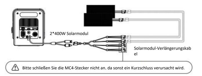
Wenn es ungenutzte Anschlüsse am Photovoltaik-Anschluss gibt, schließen Sie bitte beide Enden des MC4 an. Andernfalls funktioniert die Solarladung nicht (siehe folgende Abbildung).
