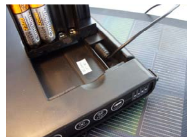
Detailansicht Batteriefach für externe Akkus und Anschluss Solarmodul
